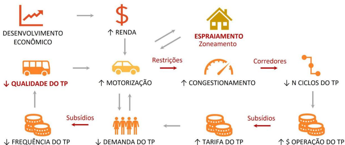
Figura 4 - Intervenções para interromper o ciclo vicioso de aumento do uso do carro e piora do transporte público (Fonte: adaptado de (Ortúzar e Willumsen, 2011))
